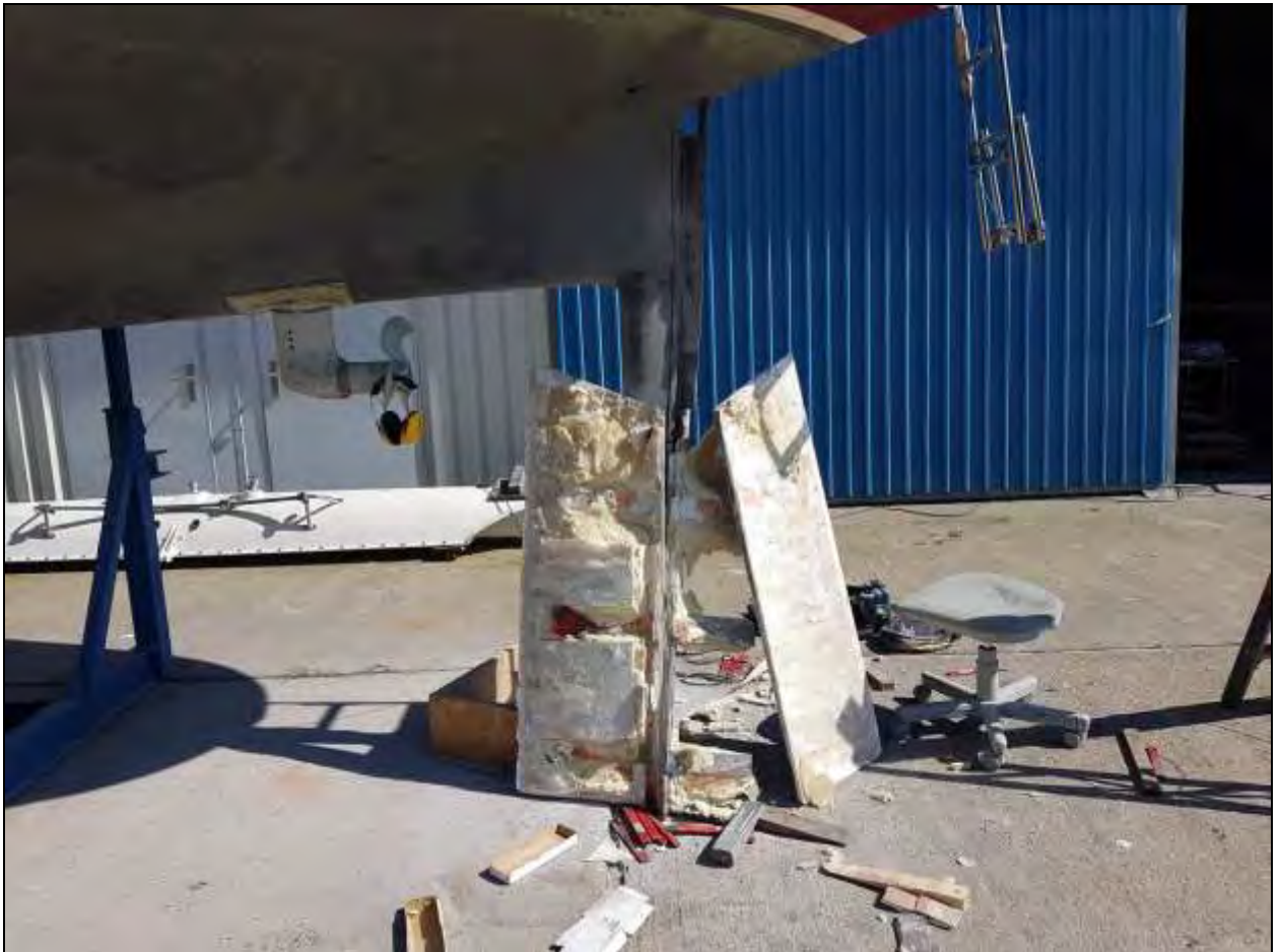
Bild: Das „gespaltene“ Ruderblatt mit seinem Innenleben
