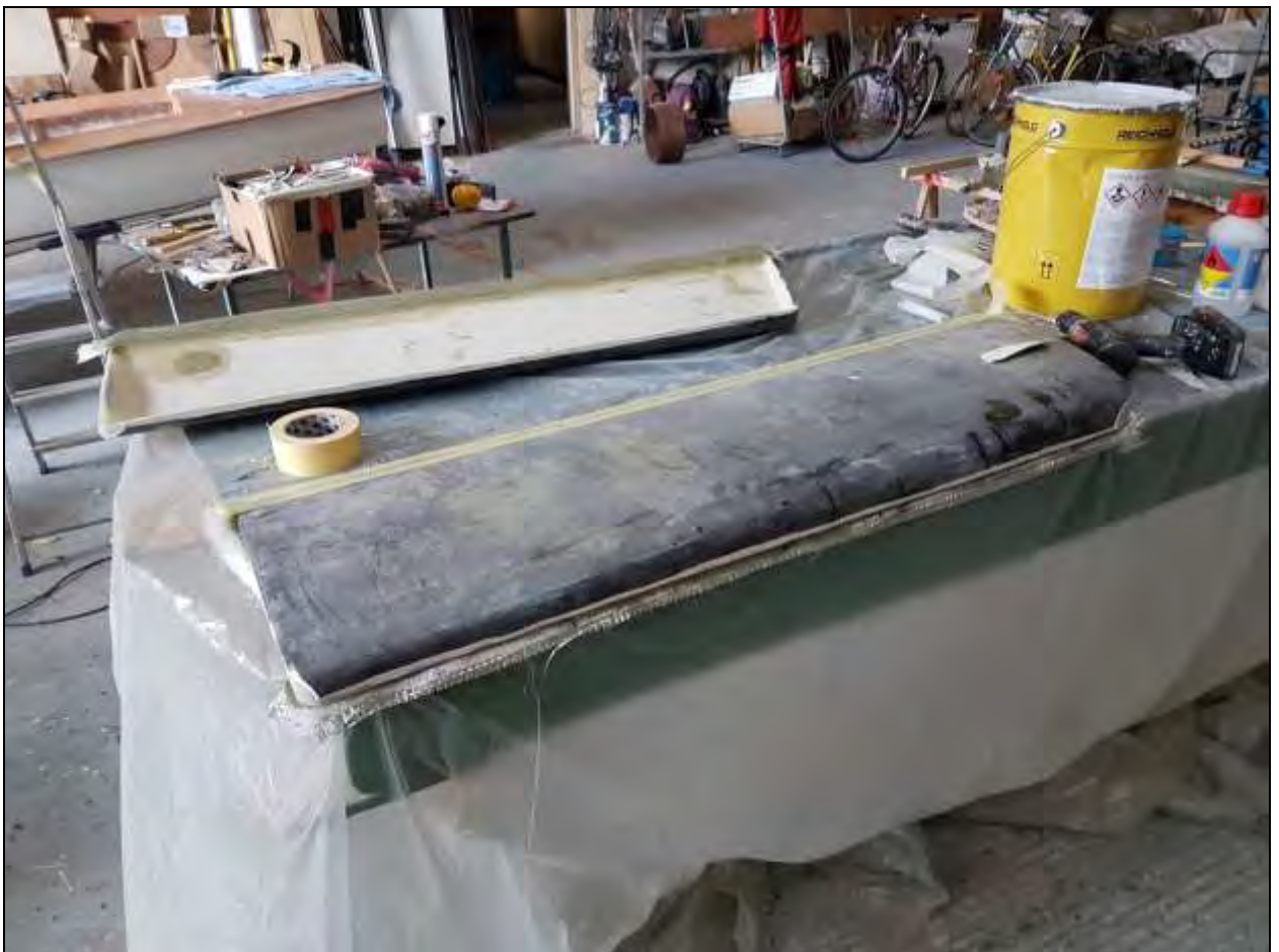
Bild: Die vorbereiteten Ruderblatthälften...
