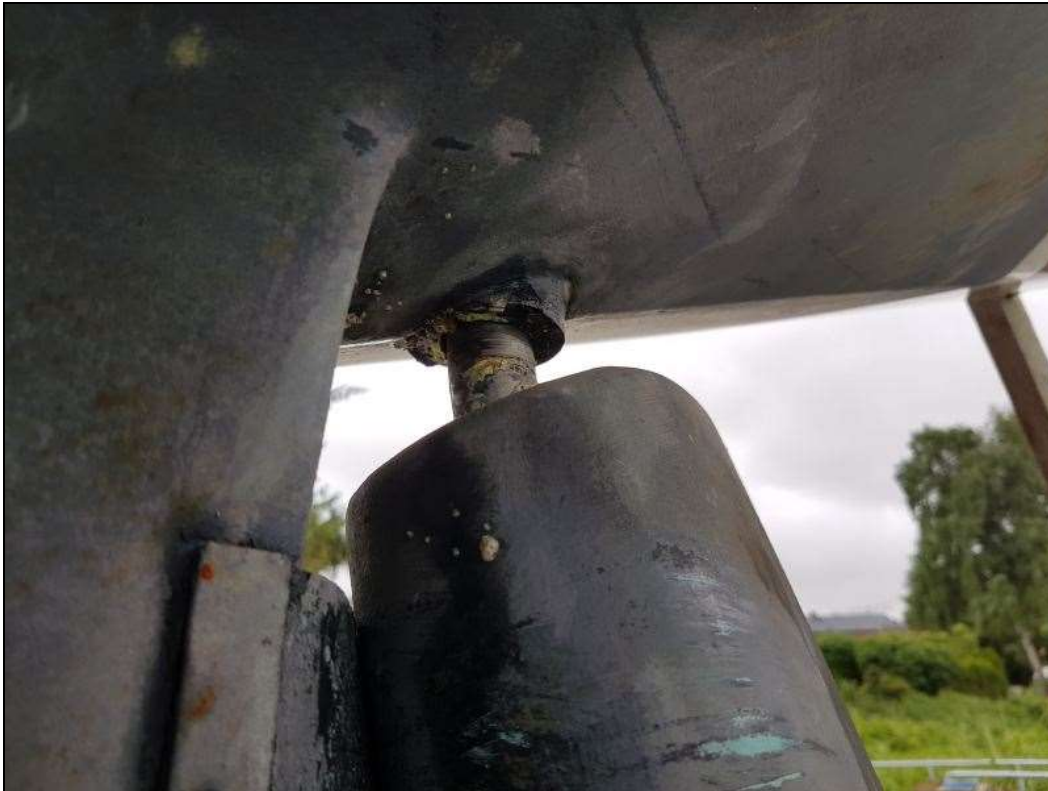
Bild: Ruderwelle am Rumpfausgang ca. 10 Grad verbogen durch den Wasserdruck
