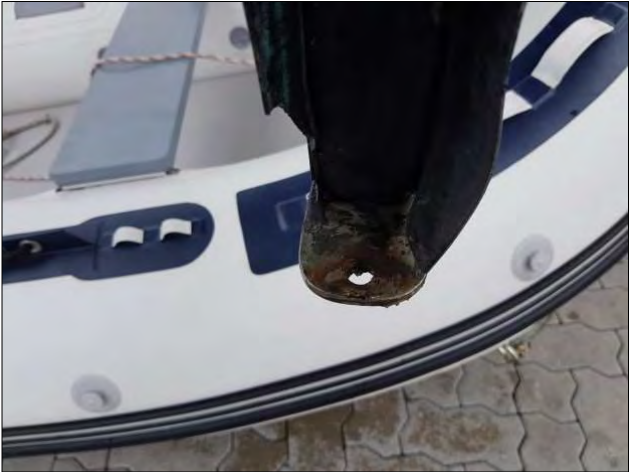
Bild: Statt Loch müsste hier ein aufgeschweißter „Pinn“ sein, der steckt nun aber im Ruderblatt
